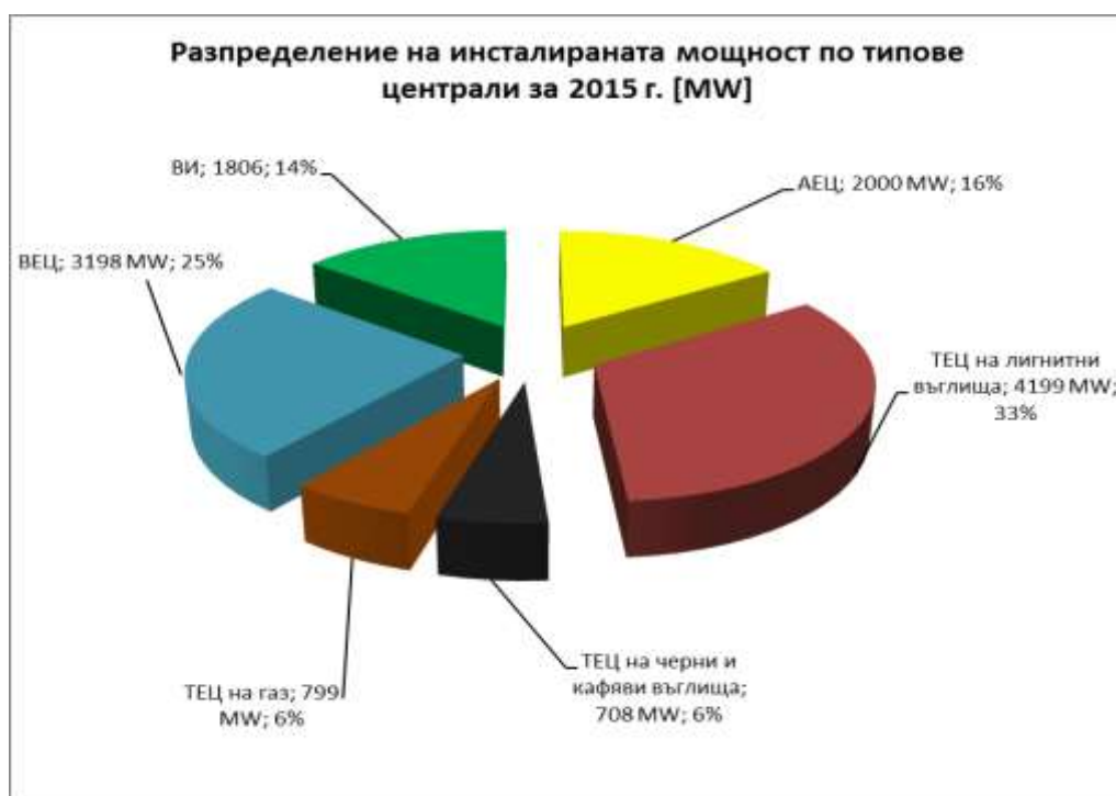
Фиг. 1 - Процентно разпределение на инсталираната мощност по типове централи по данни на ЕСО ЕАД
